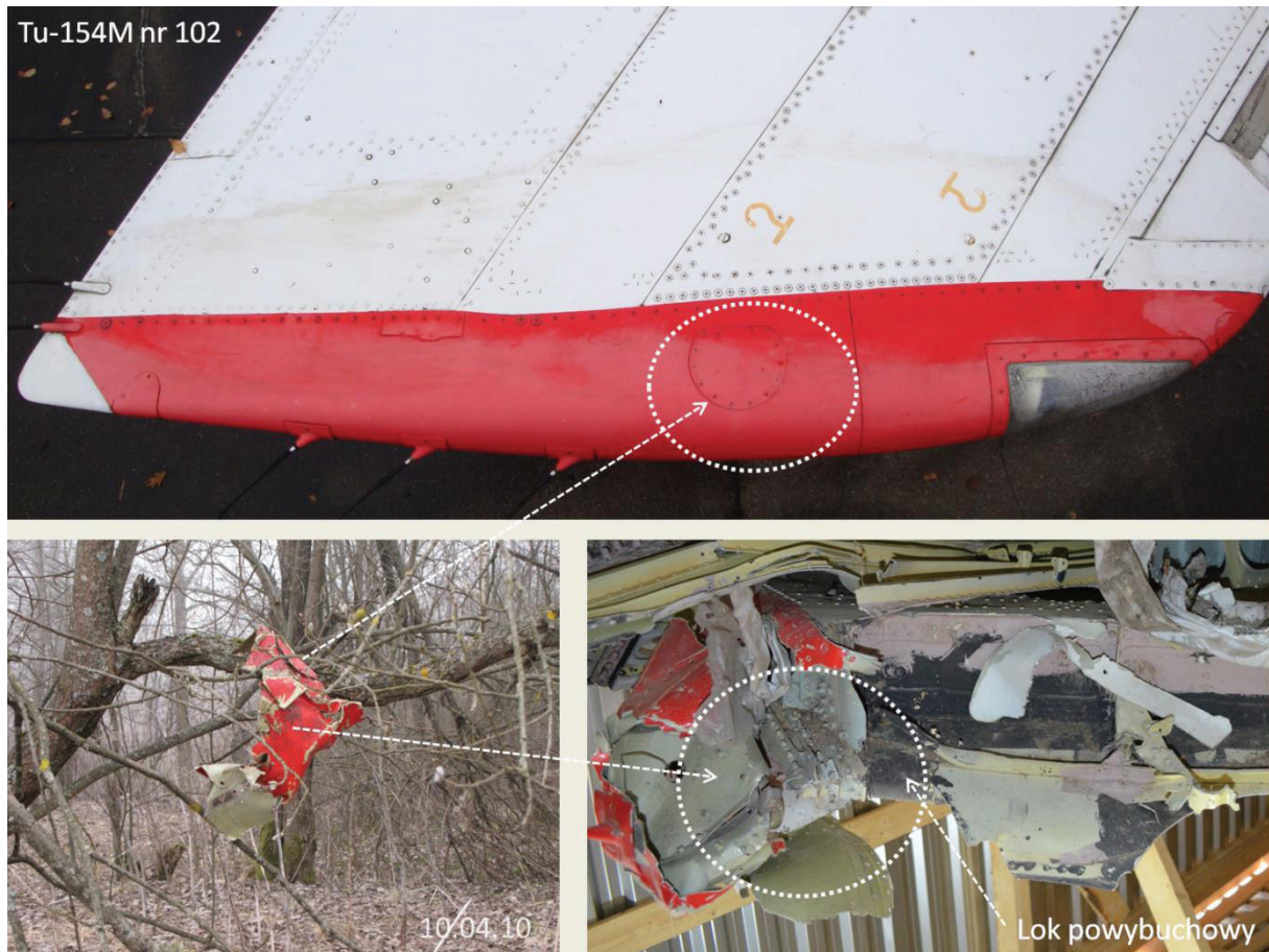
Rys. 2.207 Odlamek owiewki aerodynamicznej, koloru czerwonego, prawego skrzydła, wiszący na gałęziach drzewa, pochodził z miejsca zaznaczonego białą przerywaną elipsą
