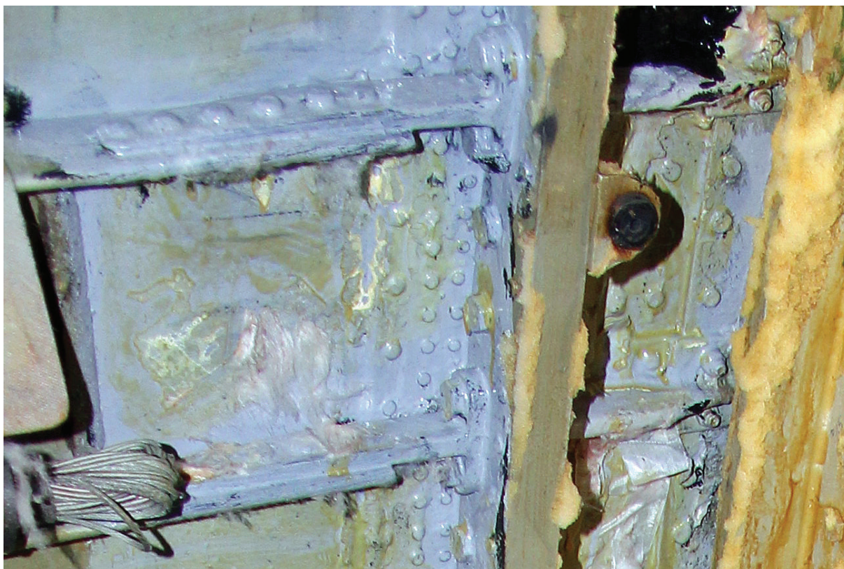
Rys. 2.83 Krótka podłużnica wychodząca z wręgi 66, połączona z nią dwoma śrubami, łączy się 6 nitami z długą podłużnicą idącą do wręgi 65. Nity te mają średnice 6,5 mm i 5 mm
