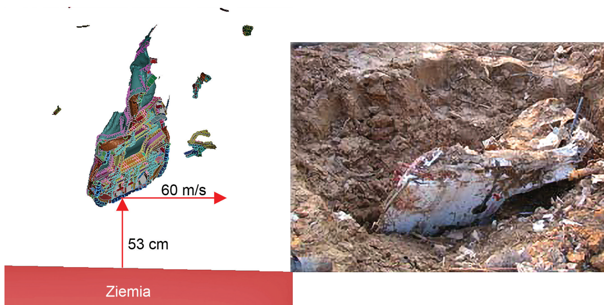
Rys. 2.238 Drzwi odbite od ziemi w symulacji NIAR i lecące poza miejsce ich wbicia w ziemię na wrakowisku
