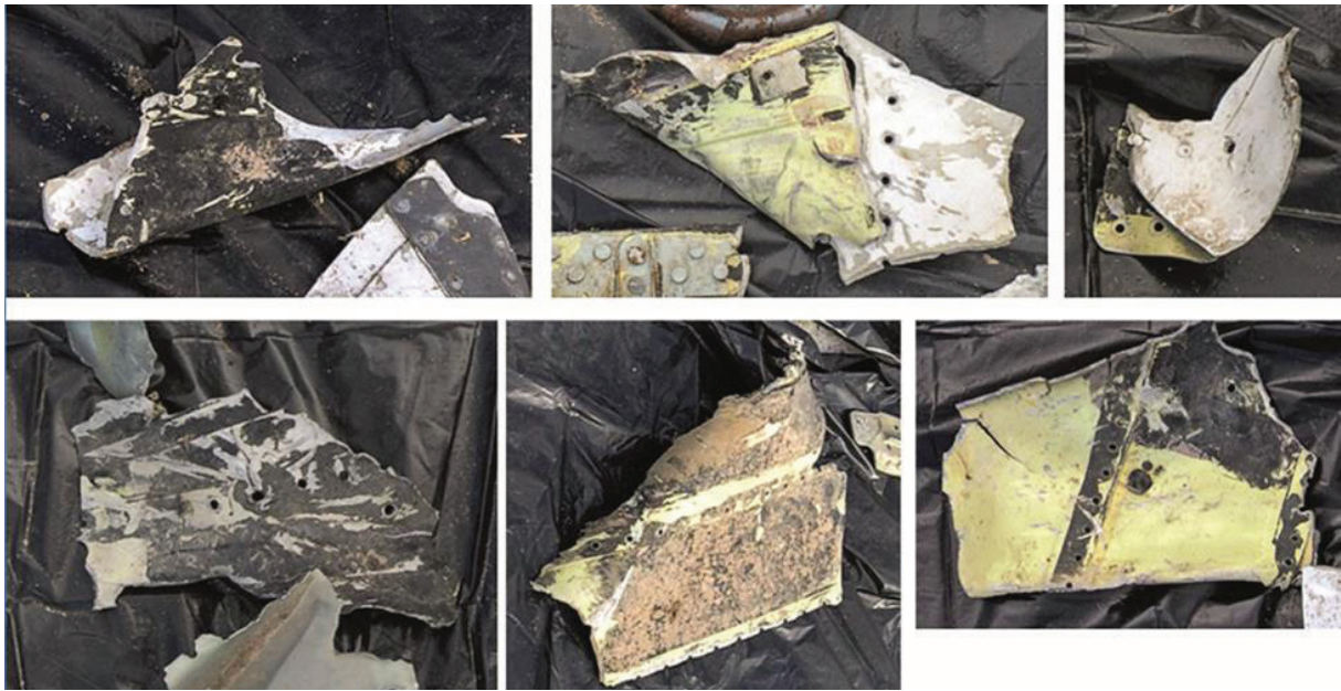
Rys. 2.121 Odlamki poszycia spodniego wywinięte na zewnątrz konstrukcji
