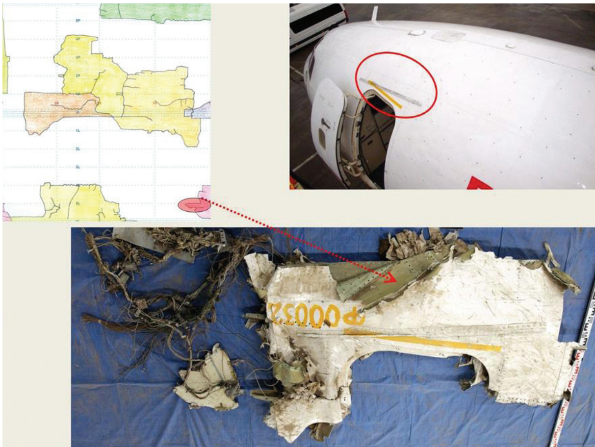
Rys. 2.156 Odlamek poszycia wierzchniego z łokiem powybuchowym, znajdujący się w strefie „A” nad kokpitem, między wręgami 10–11 i podłużnicami 4L–6L
