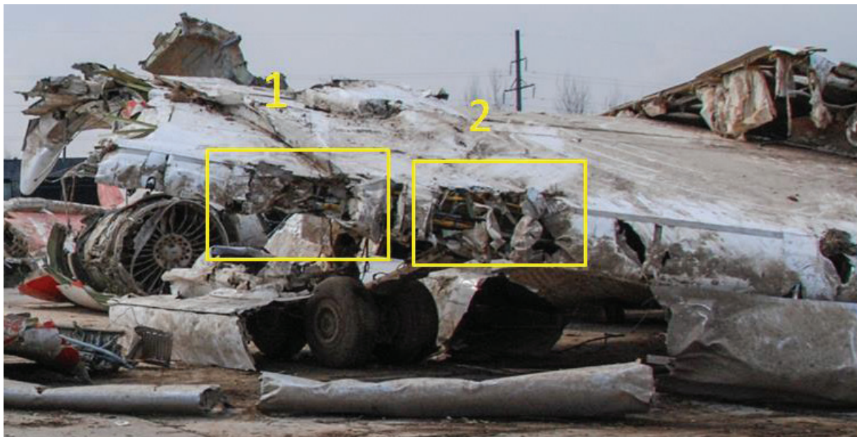
Rys. 2.236 Miejsca kontaktu z drzewami – prawe skrzydło
