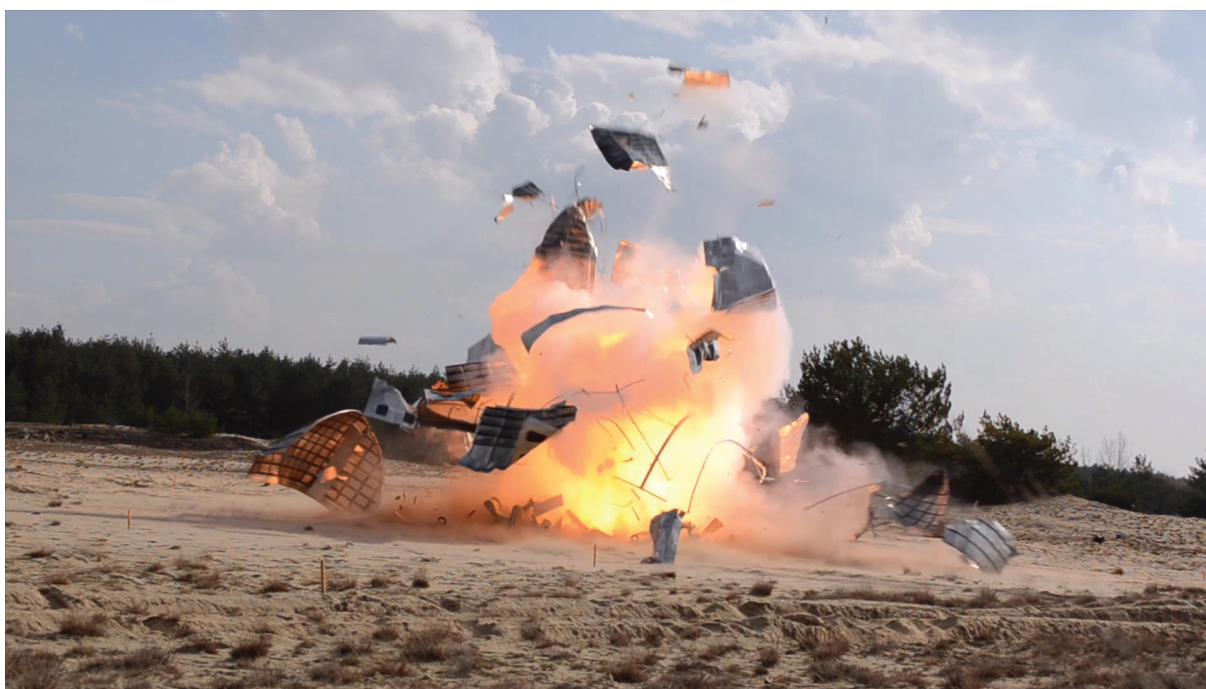
Rys. 2.103 Wybuch ładunku termobarycznego w modelu części pasażerskiej samolotu
