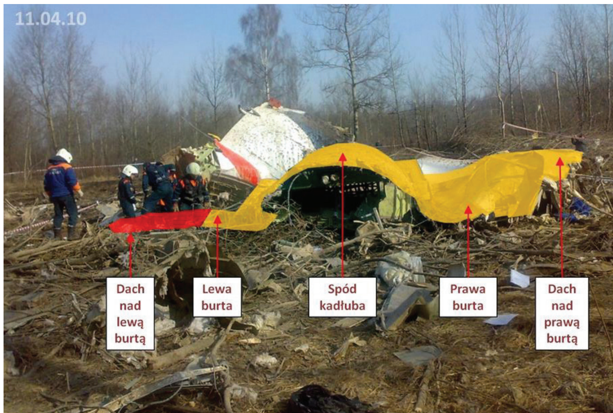
Rys. 2.200 Wrak kadłuba pomiędzy centroplatem a ogonem z wywiniętymi na zewnątrz burtami. Kolorem czerwonym zaznaczono dach nad lewą burtą, odcięty wieczorem 11.04.2010 r.
