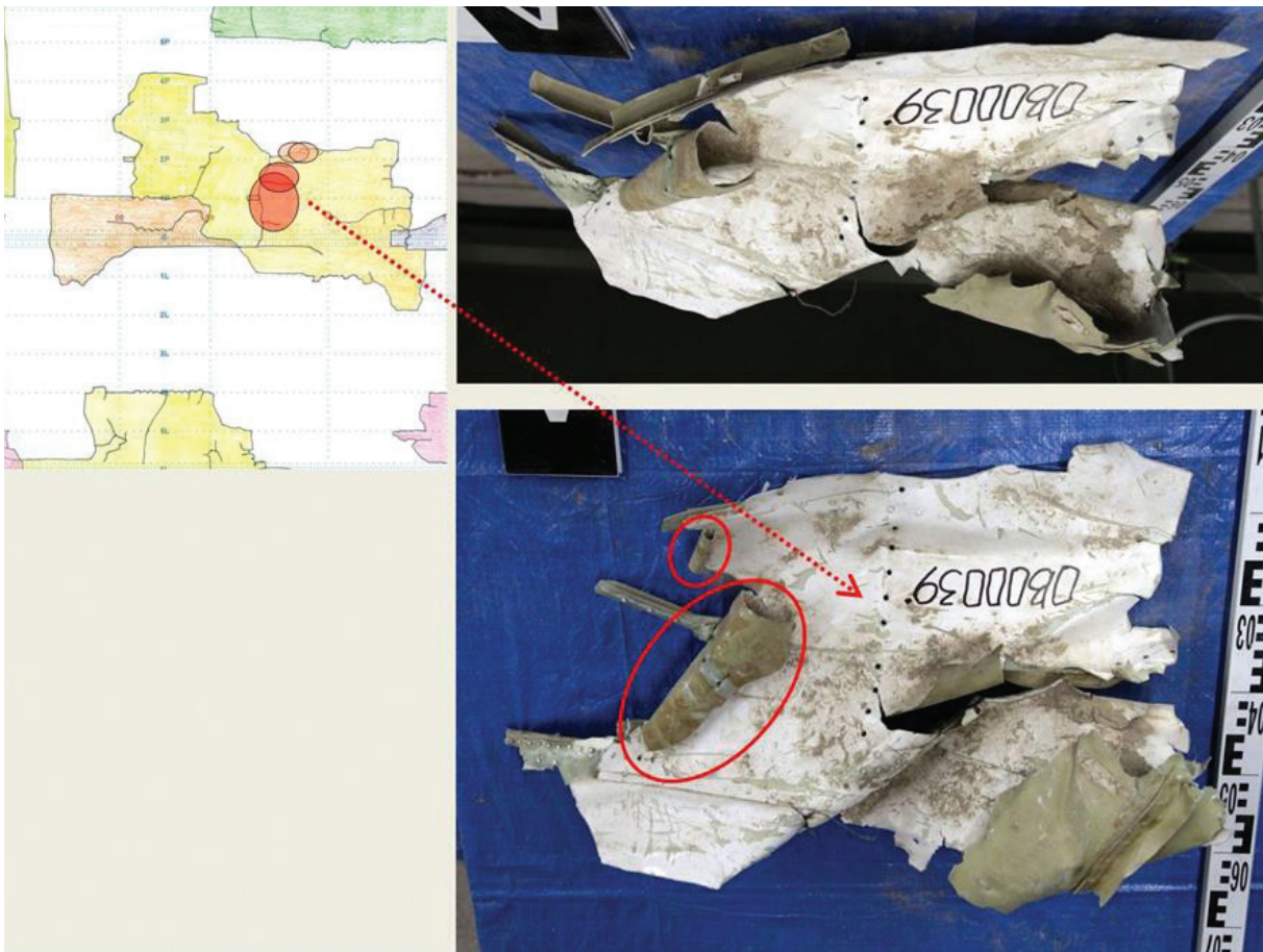
Rys. 2.158 Odlamek poszycia wierzchniego z dwoma lokami powybuchowymi, znajdujący się w konstrukcji Tu-154M nad kokpitem, między wręgami 8-11 i podłużnicami 2L-4P
