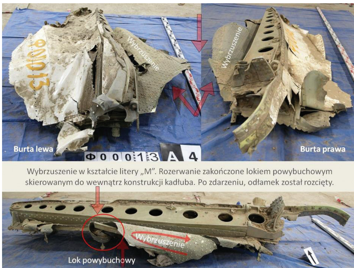
Rys. 2.193 Rozcięty odłamek poszycia wierzchniego z łokiem powybuchowym, znajdujący się w konstrukcji Tu-154M między wręgami 63–66 i podłużnicami 7L–7P, nad pomieszczeniem technicznym oraz toaletą przy burcie prawej i grodzi ciśnieniowej
