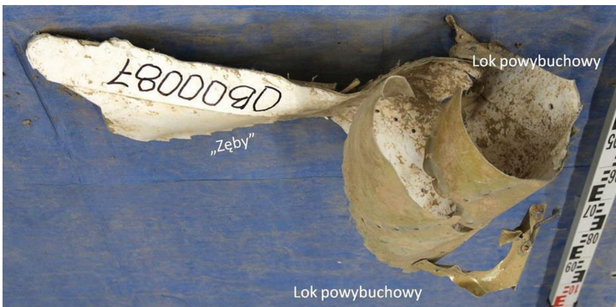
Rys. 2.189 Detale odlamka poszycia wierzchniego z dwoma lokami powybuchowymi
