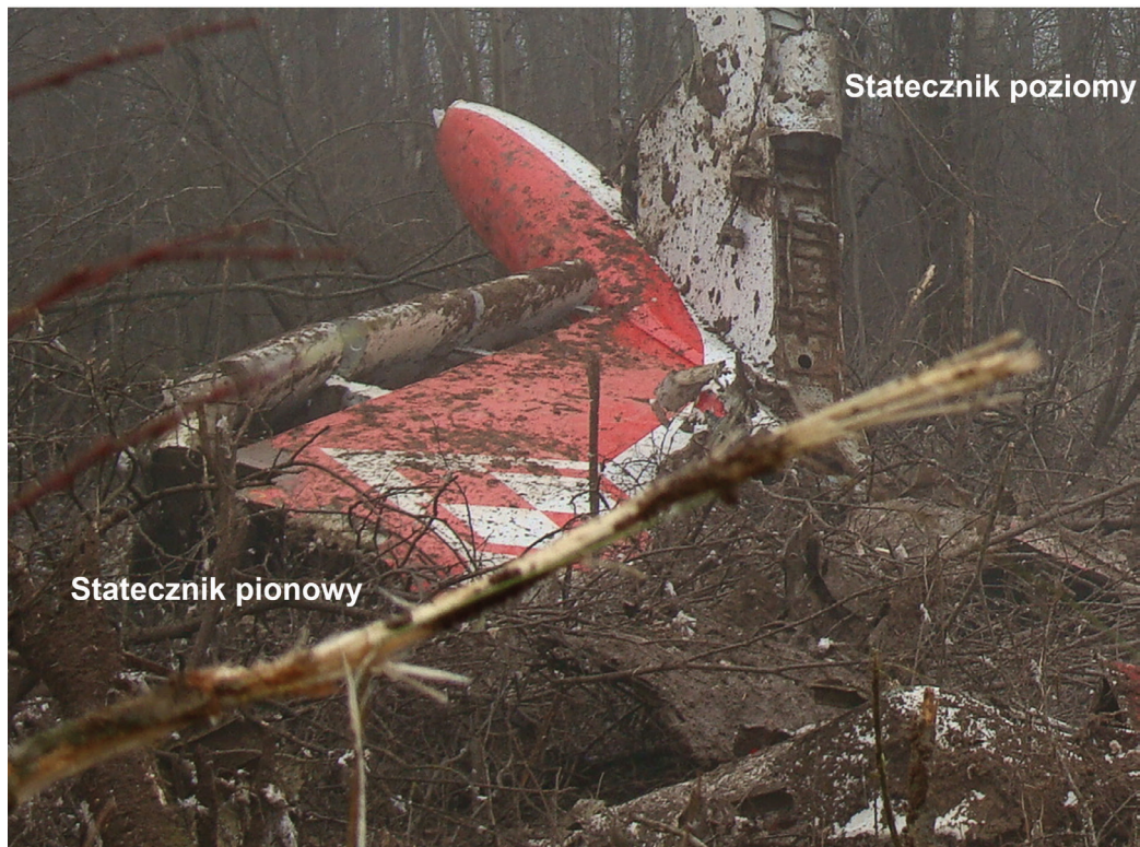
Rys. 2.240 Oderwany statecznik poziomy od statecznika pionowego w symulacji NIAR i połączone stateczniki na wrakowisku
