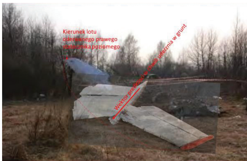
Rys. 2.137 Pozycja struktury stateczników w momencie uderzenia w południową bruzdę
