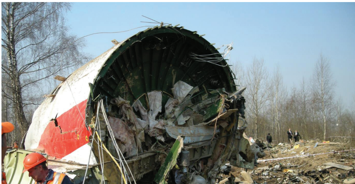
Rys. 2.86 Część ogonowa na wrakowisku z wyrwanymi na wrędze elementami mocującymi
