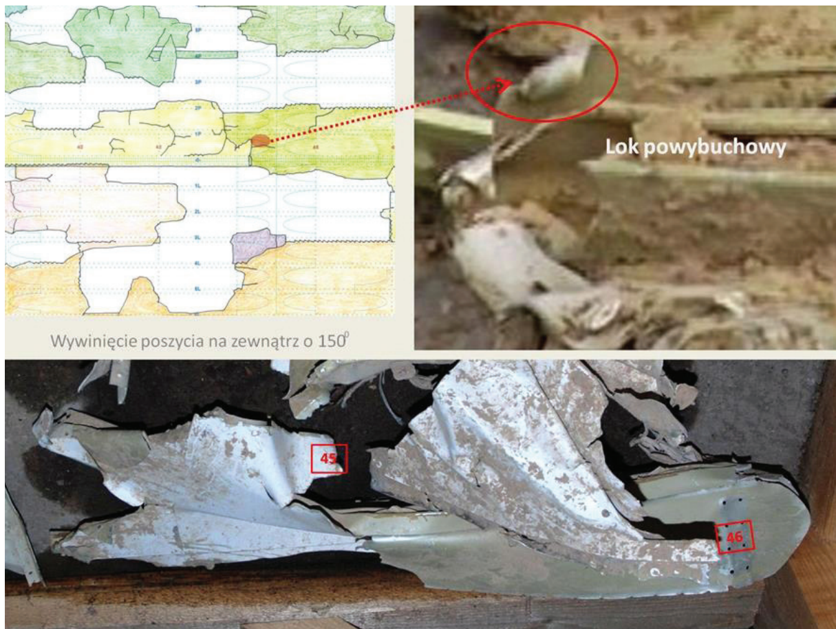
Rys. 2.173 Odlamek poszycia wierzchniego z lokiem powybuchowym, znajdujący się w konstrukcji Tu-154M między wręgami 44–47 i podłużnicami 0–2P, nad przedziałem ogólnopasażerskim
