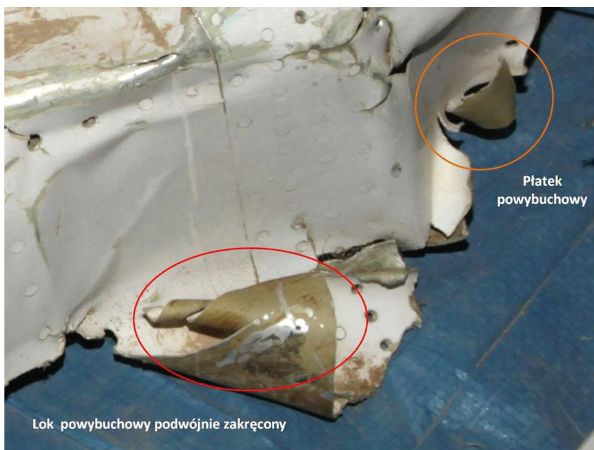
Rys. 2.161 Widok loku powybuchowego podwójnie zakręconego oraz płatka powybuchowego
