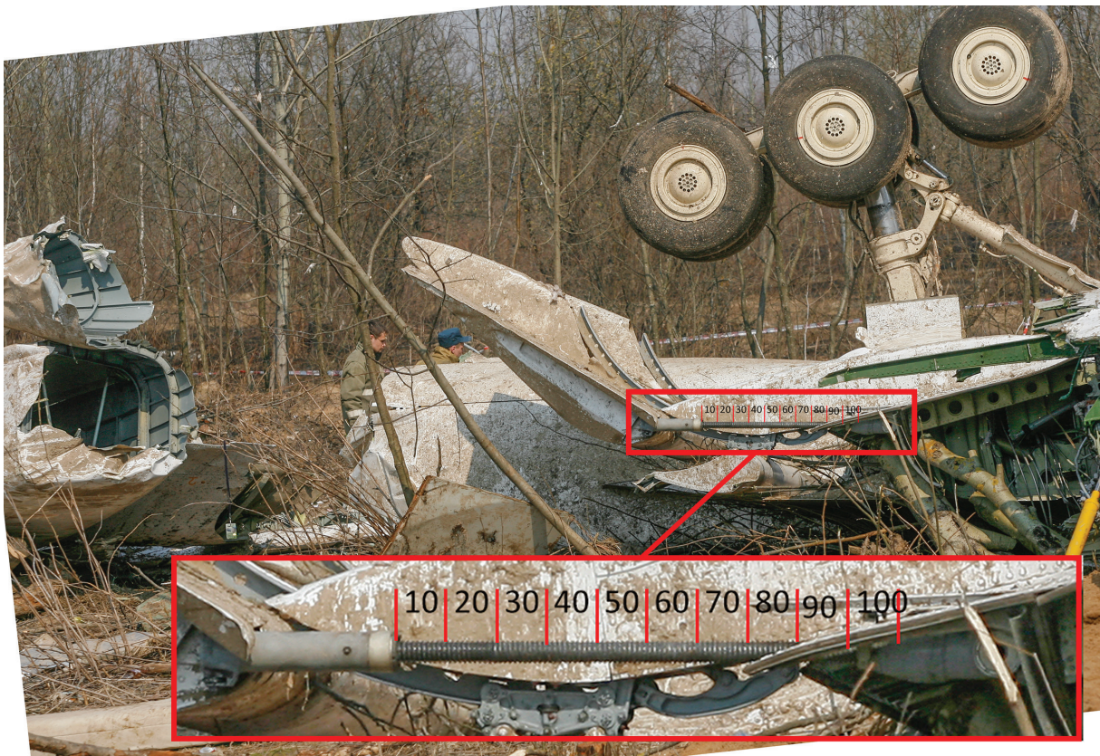
Rys. 2.94 Służby rosyjskie podczas przestawiania pozycji kłap prawego centroplatu 11.04.2010 r. oraz kłapa prawego centroplatu po przestawieniu – pozycja 45°. Fot. Prokuratura FR
