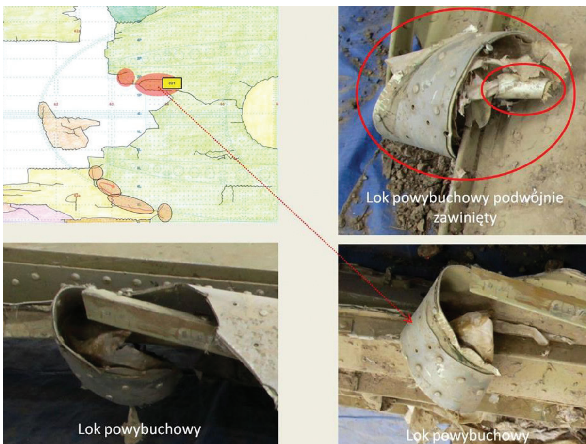
Rys. 2.182 Rozcięty odłamek poszycia wierzchniego z lokiem powybuchowym podwójnie zawiniętym, znajdujący się w konstrukcji Tu-154M między wręgami 63–66 i podłużnicami 7L–7P, nad pomieszczeniem technicznym oraz toaletą przy prawej burcie i grodzi ciśnieniowej
