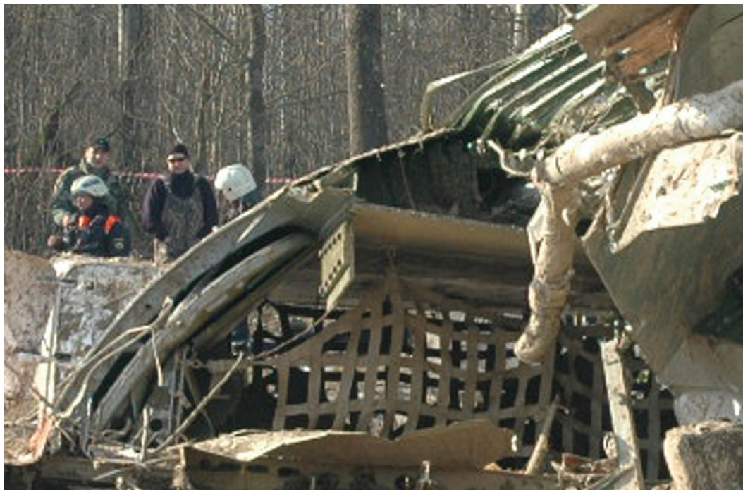
Rys. 2.241 Tylna część sekcji pasażerskiej kadłuba samolotu wraz grodzią ciśnieniową w symulacji NIAR. Na wrakowisku sekcja pasażerska nr 5 jest otwarta na przestrzał
