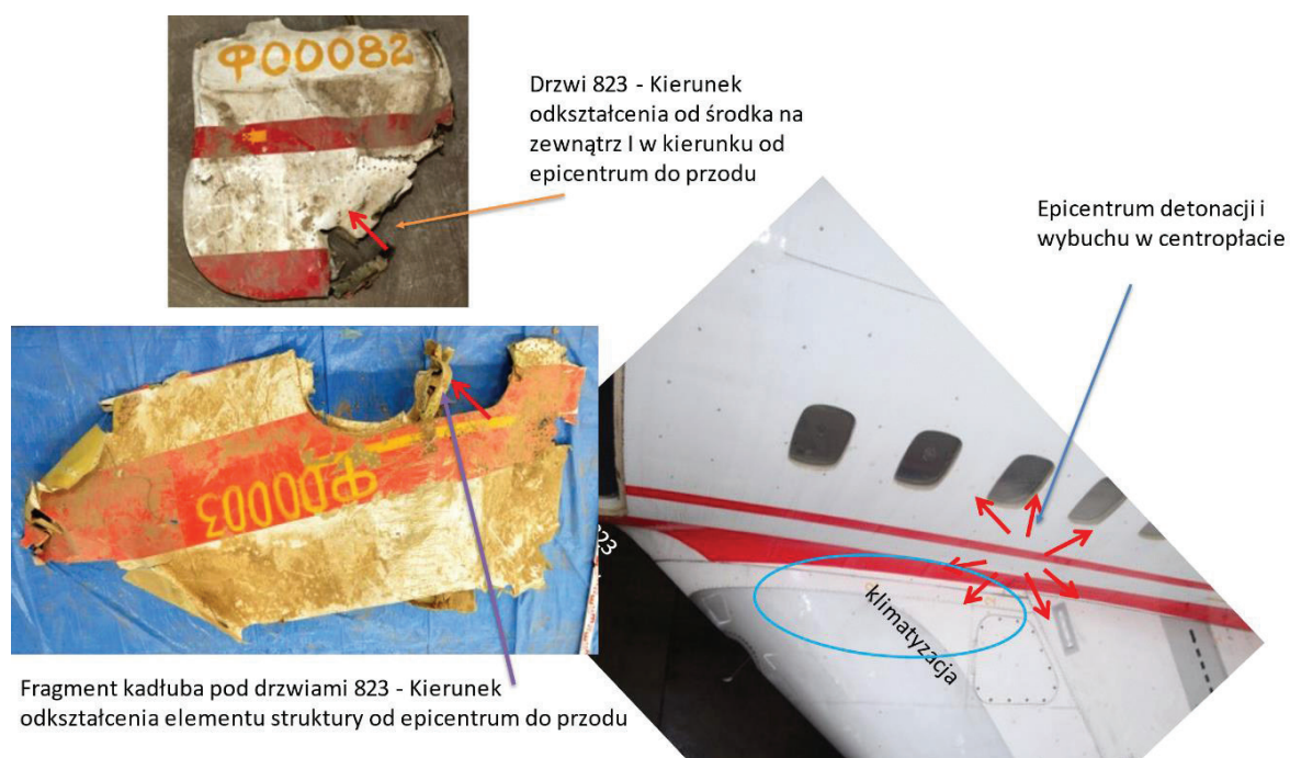
Rys. 2.256 Zniszczenie poszycia w dolnym rogu drzwi 823 bliżej centroplatu i jego odkształcenie
