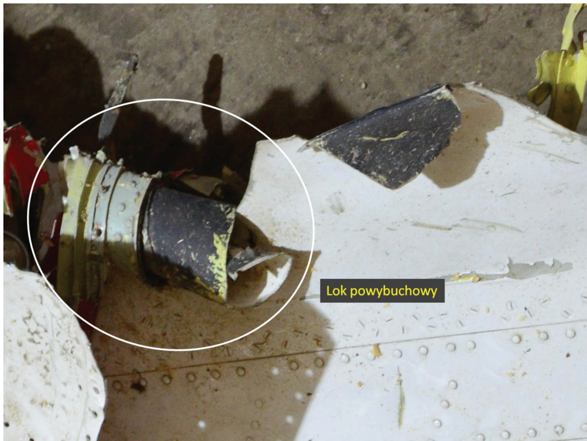
Rys. 2.208 Lok powybuchowy w miejscu oderwania fragmentu owiewki aerodynamicznej końcówki prawego skrzydła Tu-154M
