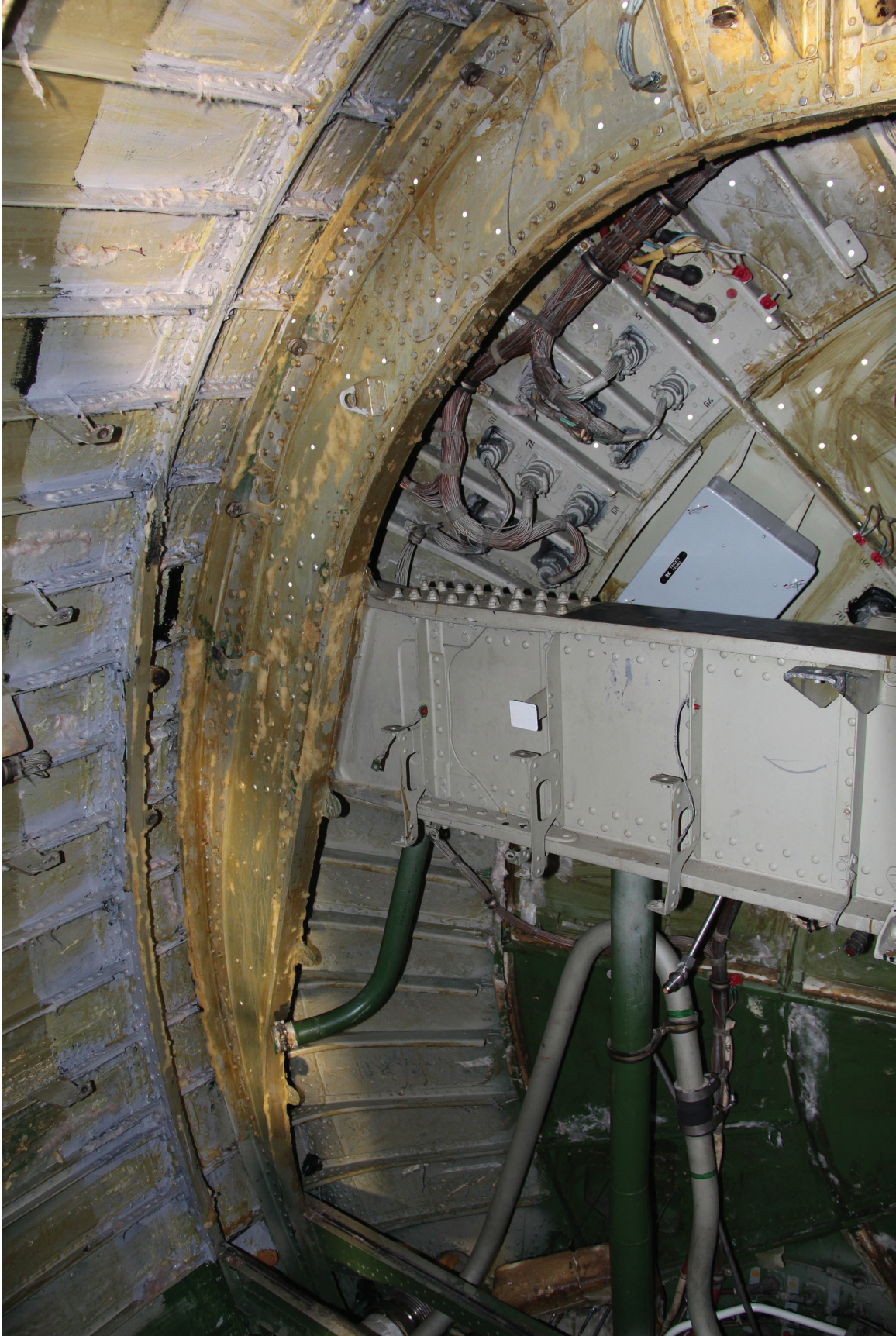
Rys. 2.82 Prawa strona wręgi 66 i 67. Wręgi w samolocie Tu-154M rozmieszczone są w większości co 50 cm, tutaj między wręgami 66 i 67 jest mniejsza odległość
