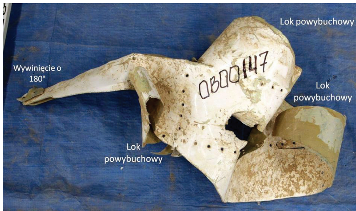
Rys. 2.186 Detale odlamka poszycia wierzchniego z trzema lokami powybuchowymi
