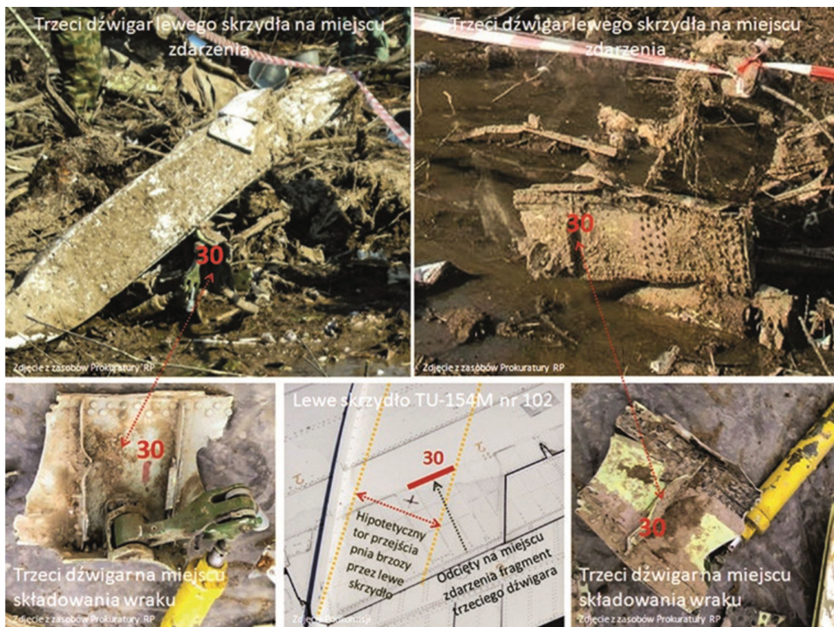
Rys. 2.126 Widoki tego samego fragmentu dźwigara nr 3 odejmowalnej części lewego skrzydła na głównym polu szczątków i miejscu składowania odłamków
