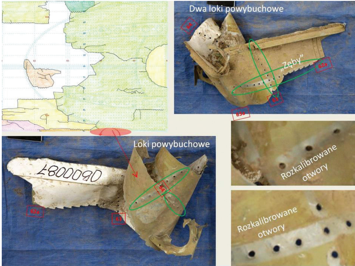
Rys. 2.188 Odlamek poszycia wierzchniego z dwoma lokami powybuchowymi, znajdujący się w konstrukcji Tu-154M między wręgami 62a–63 i podłużnicami 9L–6L, nad przejściem między przedziałem ogólnopasażerskim a drzwiami awaryjnymi nr 829 lewej burty
