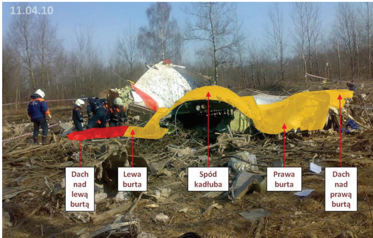
Rys. 2.176 Dach kadłuba został rozerwany wzdłuż podłużnicy 2L, między wręgami 53–57 i wywinięty wraz z burtami na zewnątrz konstrukcji. 11.04.2010 r. rozerwany dach nad lewą burtą (zaznaczony czerwonym kolorem) został odcięty i rozkawałkowany na mniejsze elementy. U góry: widok na wrakowisku
