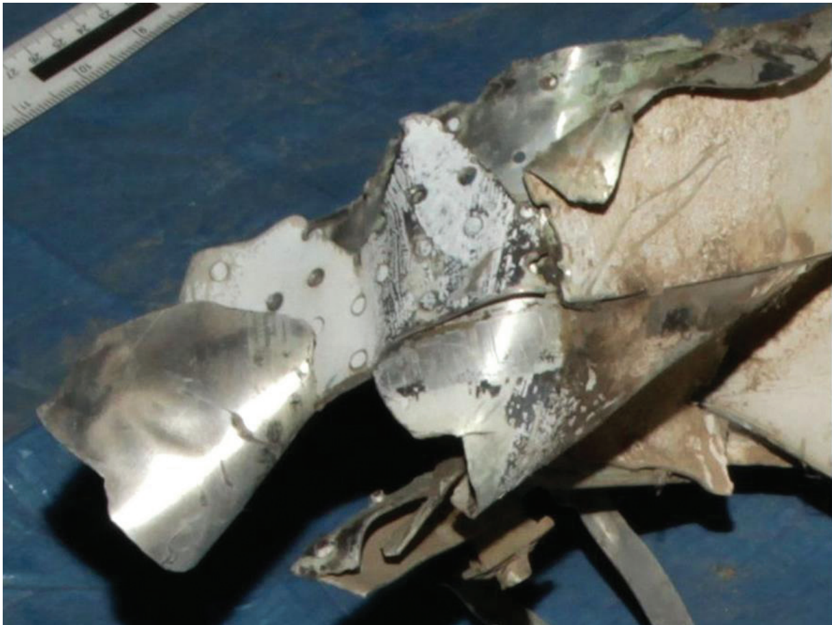
Rys. 2.162 Widok fragmentu osmolonego odłamka. Powłoka lakiernicza została częściowo złuszczone lub wypalona na skutek działania wysokiej temperatury
