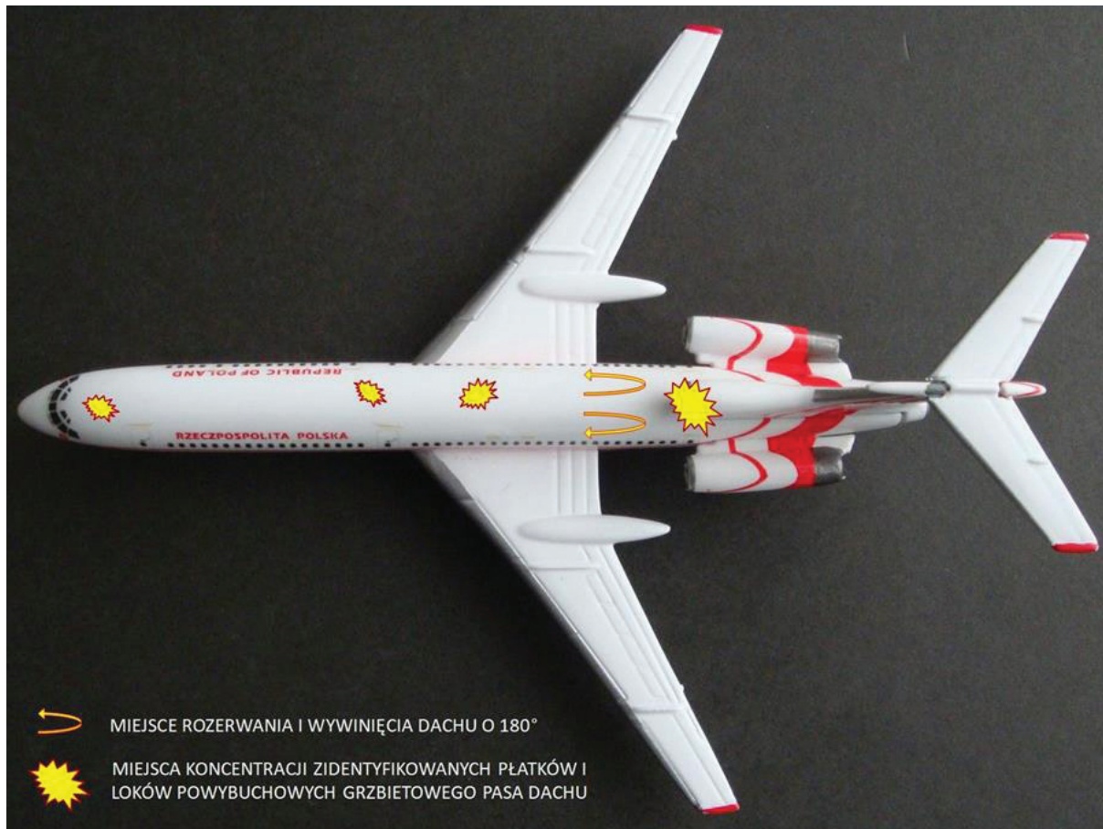
Rys. 2.196 Miejsca koncentracji zidentyfikowanych płatków i loków powybuchowych oraz rozerwanie i wywinięcie dachu na zewnątrz konstrukcji na tle sylwetki Tu-154M
