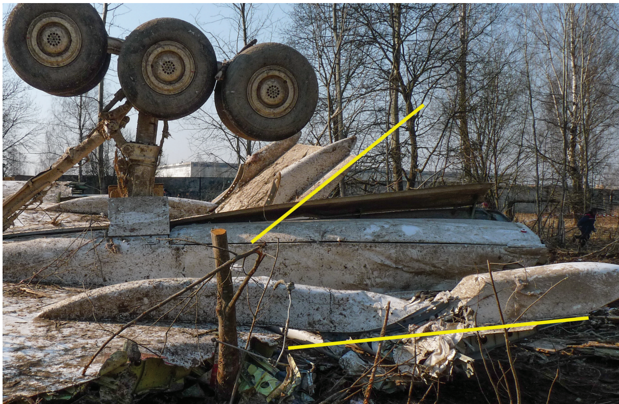
Rys. 2.95 Ustawienie obu sekcji klapy prawego skrzydła 12.04.2010 r. Kadr z fot. KBWL LP
