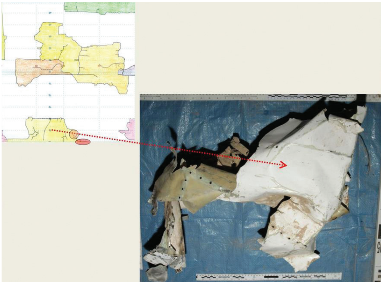
Rys. 2.160 Odlamek poszycia wierzchniego z lokiem i płatkim powybuchowym, znajdujący się w strefie „A” nad kokpitem, między wręgami 7–10 i podłużnicami 4L–6L
