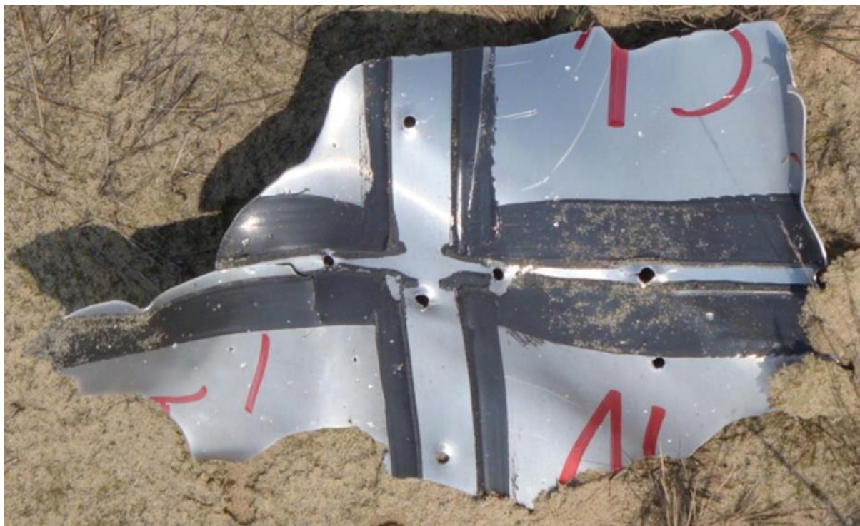
Rys. 2.191 Odlamek poszycia lewej burty z rozkalibrowanymi otworami po przecięnięciu się przez nie główki nitów oderwanych z podłużnic i wręg. Odlamek ten pochodzi ze zdetonowanej struktury rurowej w eksperymencie przeprowadzonym przez Podkomisję
