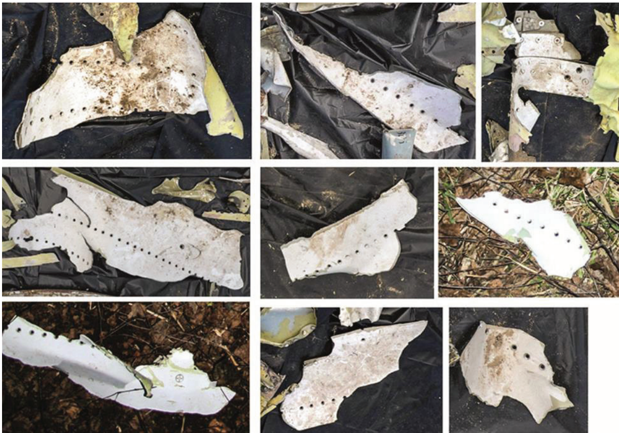
Rys. 2.120 Odlamki poszycia wierzchniego wywinięte na zewnątrz konstrukcji
