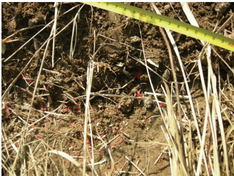
Rys. 2.136 Zdjęcie z płyty DVD załączonej do protokołu oględzin miejsca zdarzenia 10.04.2010 r. Zdjęcie zostało wykonane o godz. 16:43:35 czasu moskiewskiego w sektorze nr 13 przez śledczych Federacji Rosyjskiej. Na zdjęciu widoczna jest złuszczona powłoka lakierniczo-malarska, znajdująca się w początkowym odcinku tak zwanej południowej bruzdy, prawdopodobnie pochodząca ze statecznika poziomego
