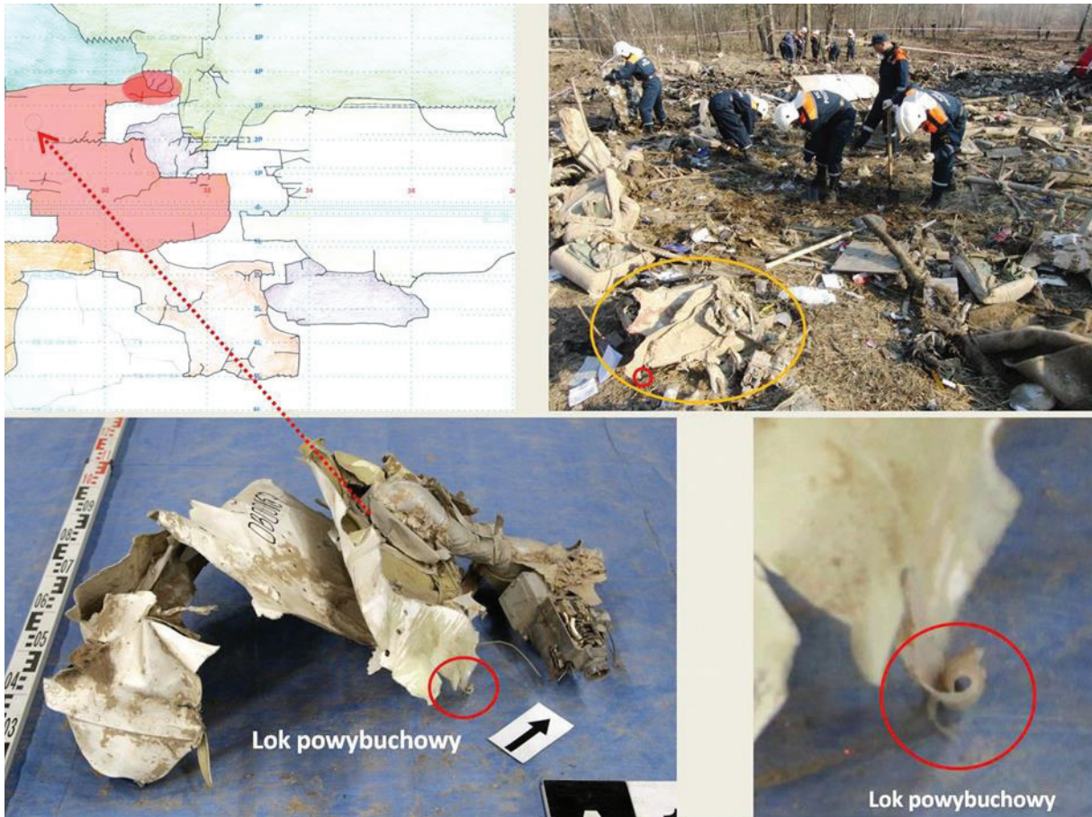
Rys. 2.165 Odlamek poszycia wierzchniego z lokiem powybuchowym, znajdujący się w konstrukcji Tu-154M między wręgami 31–33 i podłużnicami 1L–4P, nad pomieszczeniem kuchni
