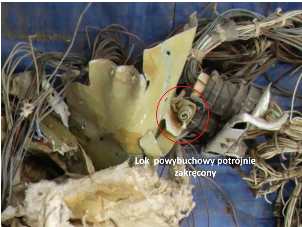
Rys. 2.157 Widok loku powybuchowego potrójnie zakręconego
