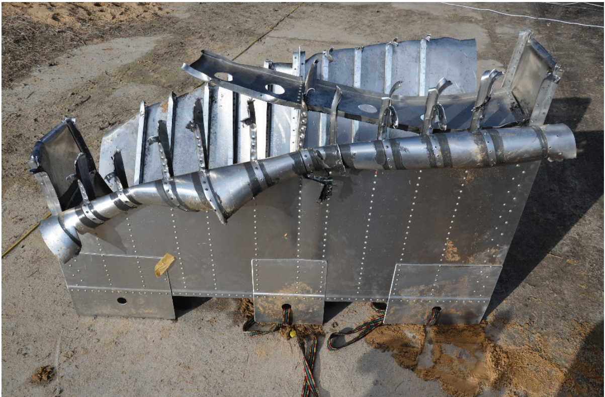
Rys. 2.172 Efekt eksperymentu rozcięcia modelu skrzydła z paliwem przy użyciu materiału wybuchowego. Skala 1:1
