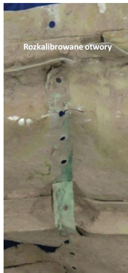
Rys. 2.159 Widok loków powybuchowych i rozkalibrowanych otworów po wyrwanych nitach
