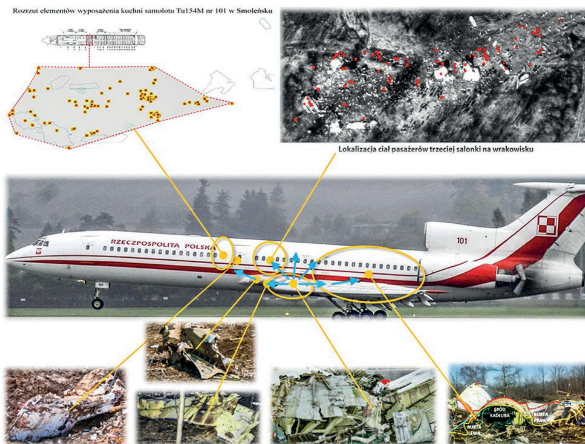
Rys. 2.146 Skutki wybuchu w rejonie zbiornika paliwowego (balastowego) nr 4. Od lewej: grafika przedstawiająca zaleganie odłamków wyposażenia kuchni, drzwi nr 823 wbite w grunt, odłamki lewej części centropłatu i przedziału pasażerskiego oraz lokalizacja ciał pasażerów
