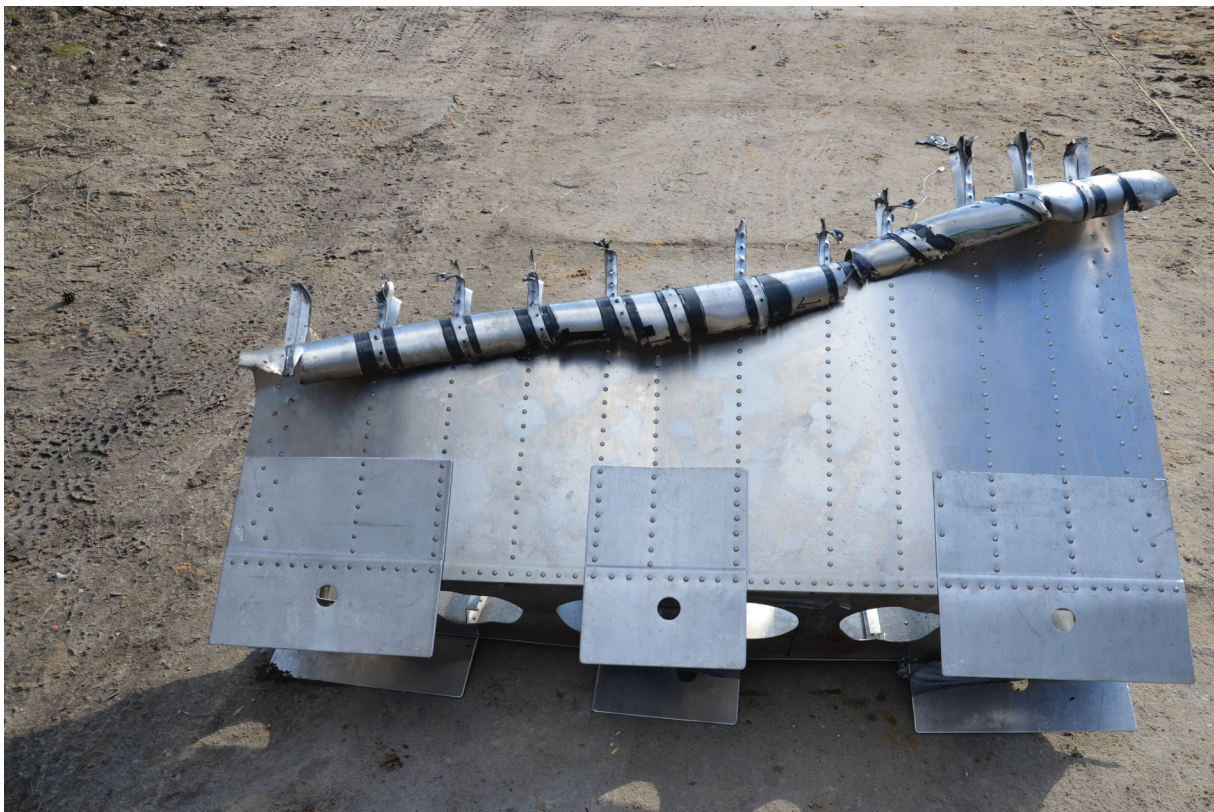
Rys. 2.110 Skala 1:1. Efekt eksperymentu rozcięcia modelu skrzydła z paliwem przy użyciu materiału wybuchowego
