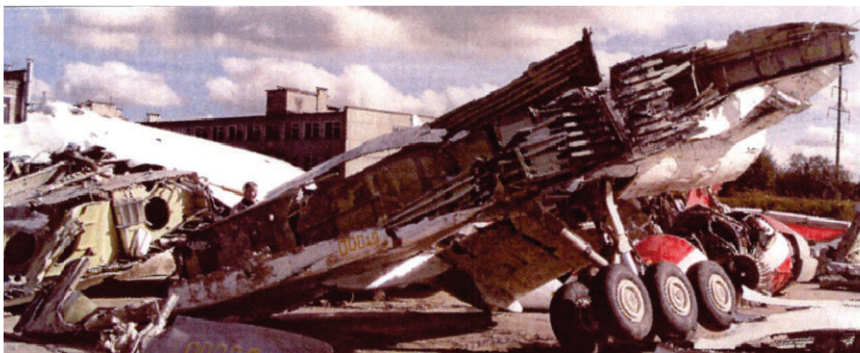
Rys. 2.150 [...] lewa środkowa część skrzydła z podpórką podwozia. Zbiornik – keson zniszczony, górna część wbita wskutek hydraulicznego udaru paliwa 126
