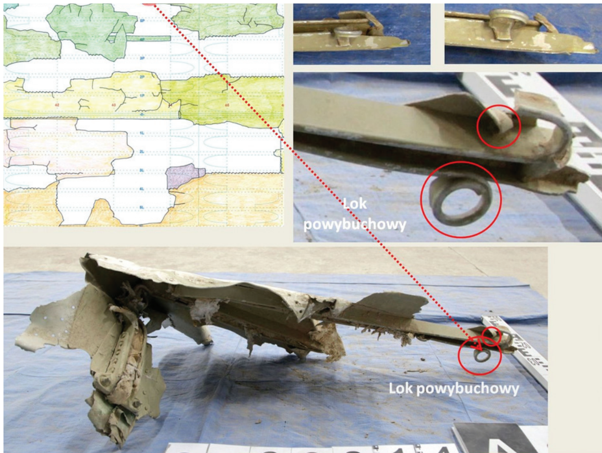
Rys. 2.171 Odlamek poszycia wierzchniego z lokiem powybuchowym, znajdujący się w konstrukcji Tu-154M między wręgami 43–46 i podłużnicami 4P–7P, nad przedziałem ogólnopasażerskim
