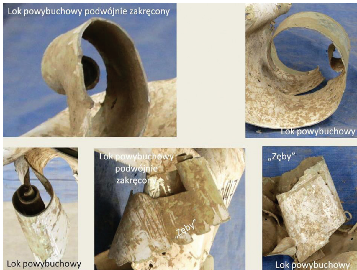
Rys. 2.187 Detale odlamka poszycia wierzchniego z trzema lokami powybuchowymi
