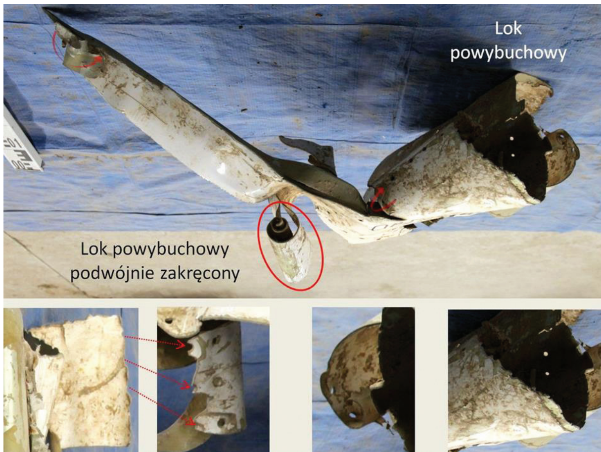
Rys. 2.184 Detale odłamka poszycia wierzchniego z trzema lokami powybuchowymi
