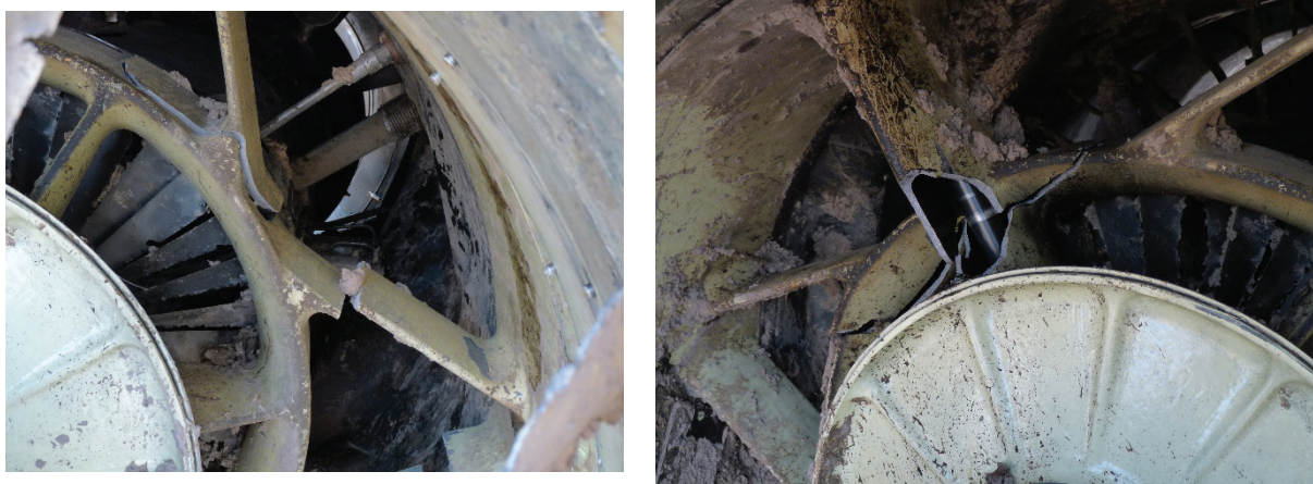
Rys. 2.73 Zniszczenia wewnętrzne silnika lewego
