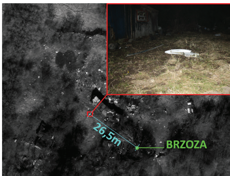
Rys. 2.90 Lokalizacja fragmentu ostatniej śruby napędu lewej sekcji klap na miejscu zdarzenia 10.04.2010 r.
