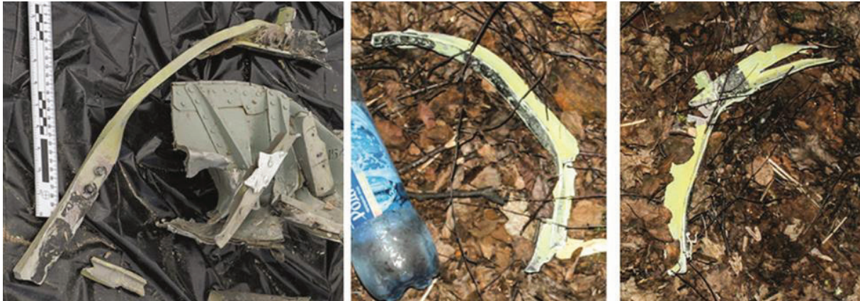
Rys. 2.119 Odlamki podłużnic wywiniętych na zewnątrz konstrukcji
