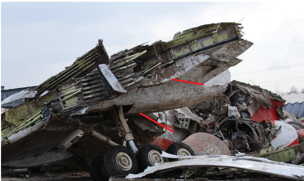
Rys. 2.88 Ustawienie klapy centroplatu i skrzydła lewego 12.04.2010 r. Fot. powyżej – materiały rosyjskie oraz powiększenie fragmentu zdjęcia KBWL LP (poniżej), z zaznaczonym przez Podkomisję nierównomiernym ustawieniem dwóch sekcji klapy na lewym skrzydle i centroplacie. Widoczne zróżnicowanie kąta wychylenia
