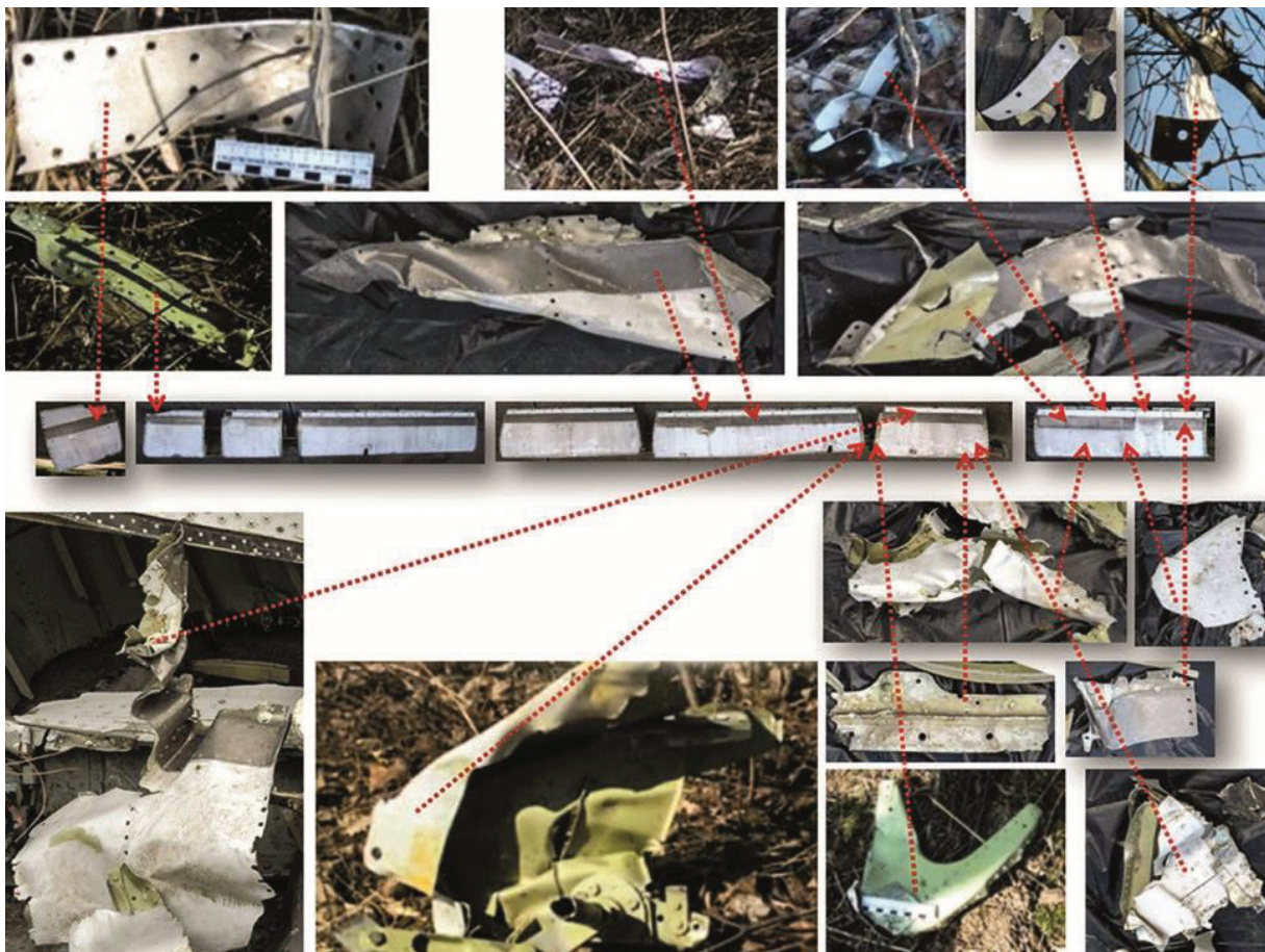
Rys. 2.127 Miejsca odłamków noska w konstrukcji odejmowalnej części lewego skrzydła
