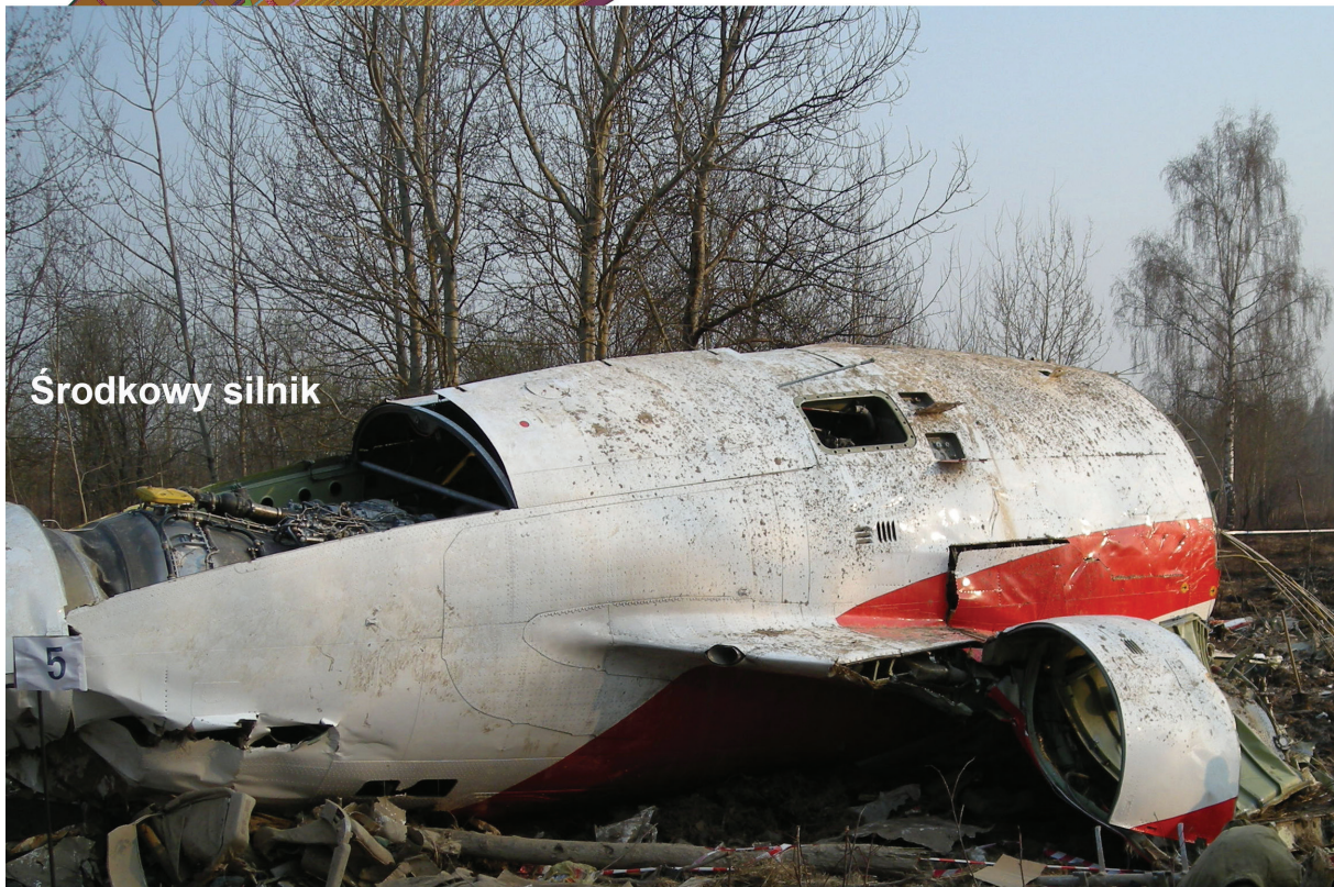
Rys. 2.239 Porównanie ogona samolotu wraz z umieszczonym wewnątrz silnikiem nr 2 w symulacji NIAR i na wrakowisku
