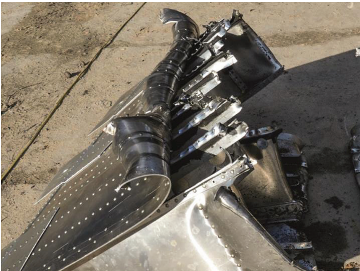
Rys. 2.133 Skala 1:1. Efekt eksperymentu wykonanego przez Podkomisję – rozcięcie modelu skrzydła z paliwem przy użyciu materiału wybuchowego
