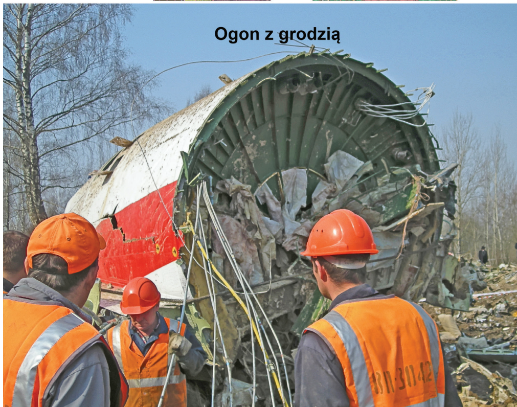
Rys. 2.242 Rozerwany ogon samolotu z wypchniętym środkowym silnikiem w symulacji i niezniszczony ogon zamknięty grodzia ciśnieniową wraz z środkowym silnikiem we wnętrzu na miejscu katastrofy
