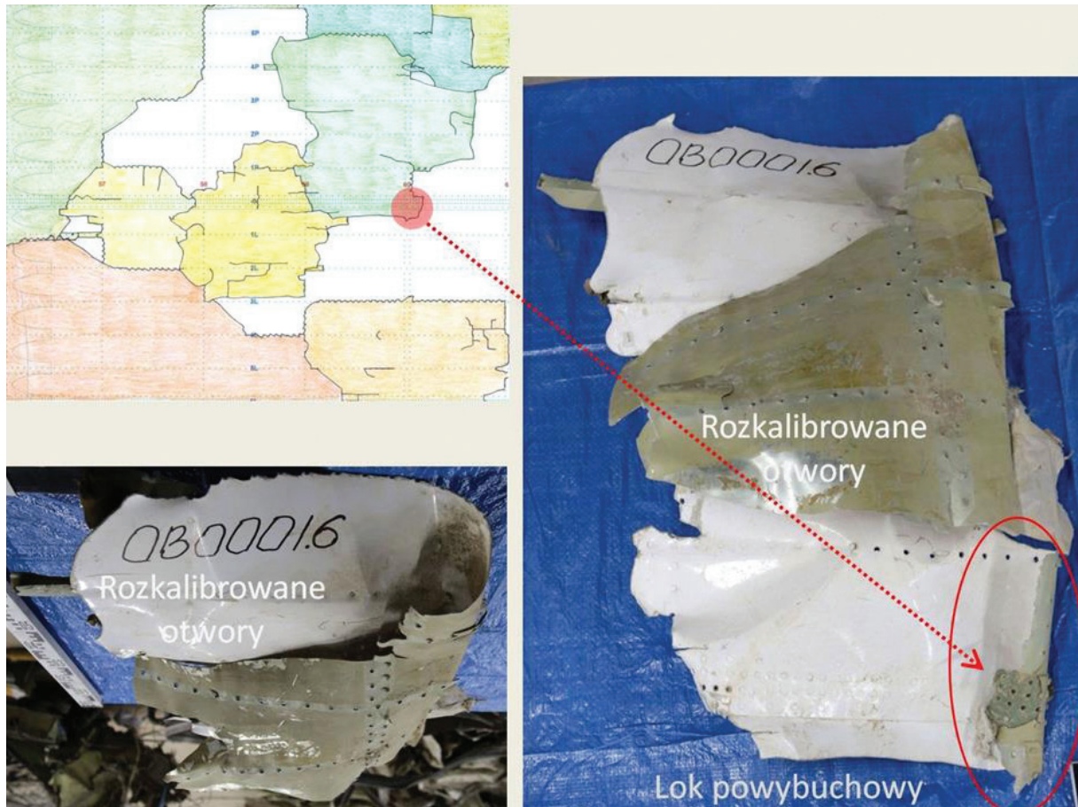
Rys. 2.179 Odlamek poszycia wierzchniego z lokiem powybuchowym, znajdujący się w konstrukcji Tu-154M między wręgami 59–61 i podłużnicami 0–5P, nad przedziałem ogólnopasażerskim
