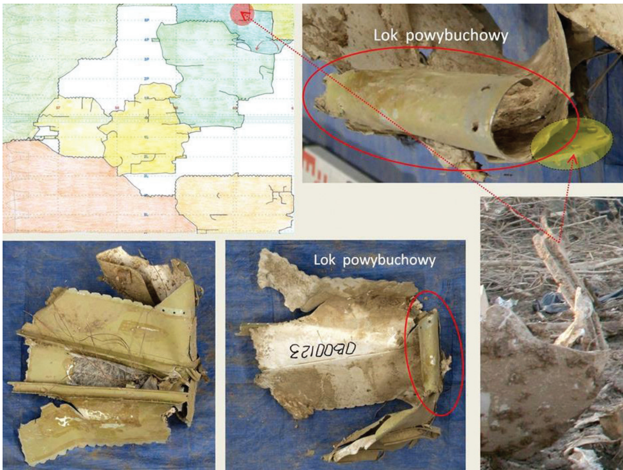
Rys. 2.178 Odlamek poszycia wierzchniego z lokiem powybuchowym, znajdujący się w konstrukcji Tu-154M między wręgami 59–61 i podłużnicami 3P–7P, nad przedziałem ogólnopasażerskim
