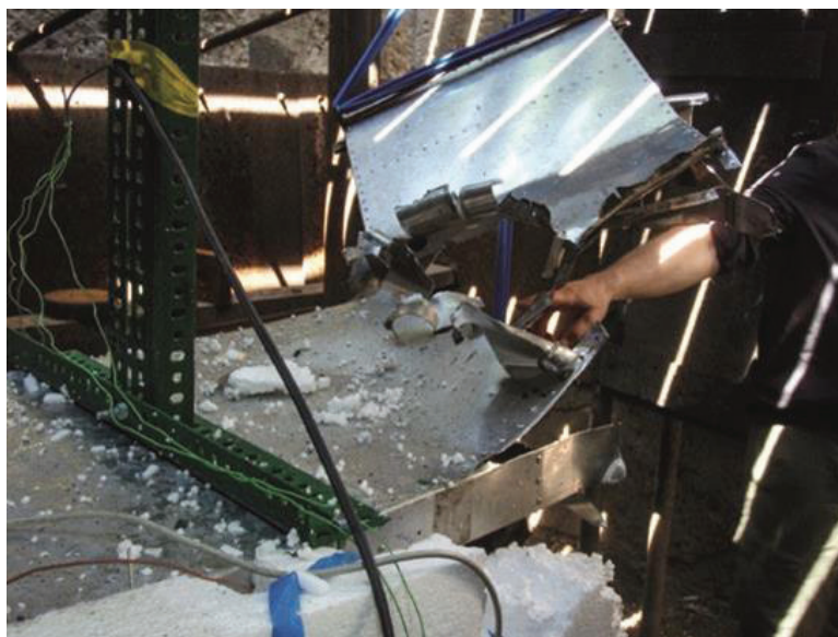
Rys. 2.134 Efekt eksperymentu rozcięcia modelu skrzydła w skali 1:4 z paliwem przy użyciu 6 g/m liniowego materiału wybuchowego. Zwraca uwagę ułożenie loków w kierunku od epicentrum dużego ciśnienia wewnętrznego 124
