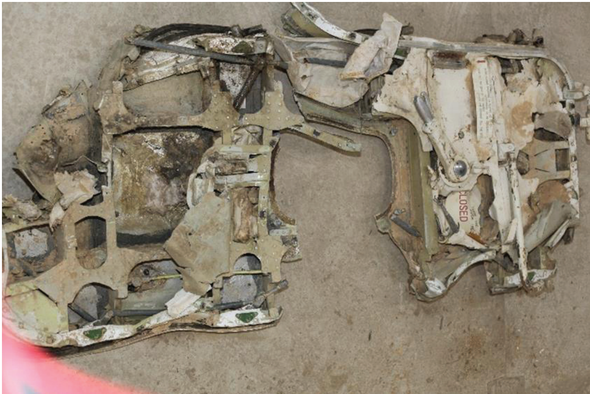
Rys. 2.255 Rzeczywiste zniszczenia odkopanych drzwi
