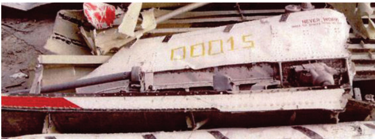
Rys. 2.152 Prawy wspornik skrzydła. Górna i przednia część poszycia zerwana w wyniku uderzenia hydraulicznego paliwa. Dolna część pokrycia bardzo zniekształcona z oderwanymi dźwigarami. Żebra kesonu zdeformowane i oderwane. Sekcja klapy zerwana z prowadnic 128 . Według protokołu oględzin ekspertów Prokuratury FR wykonanych 17–20.09.2010 r. także prawe skrzydło zostało zniszczone uderzeniem hydraulicznym
