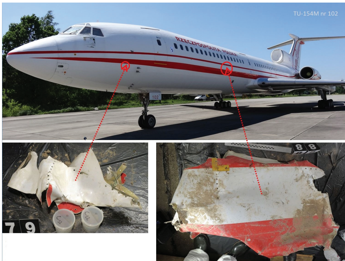
Rys. 2.102 Ślady materiałów wybuchowych (RDX) stwierdzone na wewnętrznych powierzchniach dwóch fragmentów poszycia lewej burty Tu-154M nr 101, zbadane przez polskich specjalistów i potwierdzone przez laboratorium w Kent
