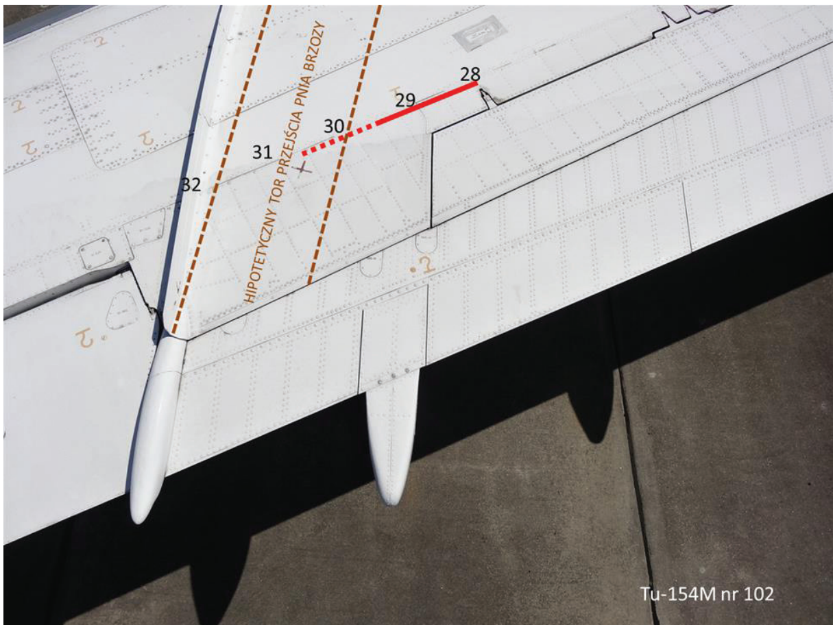
Rys. 2.203 Na poszyciu lewego skrzydła Tu-154M nr 102 zaznaczono czerwoną linią odłamek trzeciego dźwigara zidentyfikowany na głównym polu szczątków
