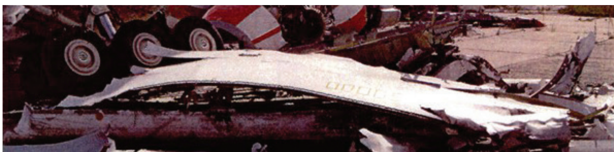
Rys. 2.151 [...] część lewej konsoli skrzydła od aerodynamicznego grzebienia do głównej podpory podwozia 127 . W rzeczywistości poszycie górne pochodzi ze skrzydła prawego, a jego powybuchowy kształt stawia znak zapytania nad sposobem zniszczenia także prawego skrzydła
