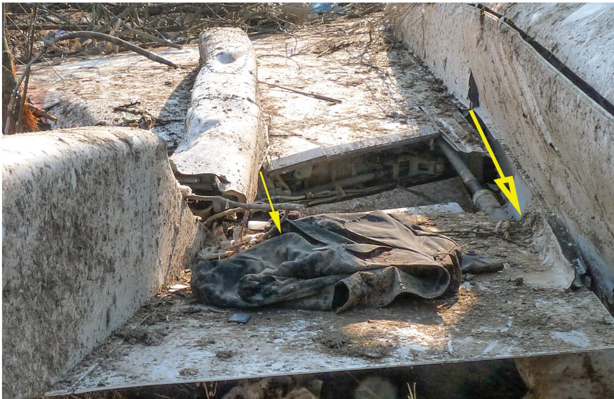
Rys. 2.96 Druga sekcja klap prawego skrzydła. Lokalizacja śruby napędu klap oraz wygięcie kłapy po przekręceniu śruby przez Rosjan. Fot. KBWL LP, 12.04.2010 r.
