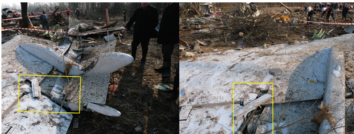
Rys. 2.98 Fotografie KBWL LP przedstawiające prawe skrzydło z zaznaczoną śrubą
