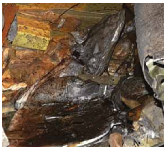
Rozbita i okopcona szyba okna prezydenckiej toalety. Rozzerwana i nadpalona tapicerka wewnętrzna. Wydmuchnięte ocieplenie i konstrukcja burty.
