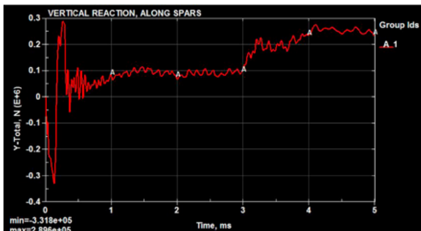
Rys.10 Przebieg czasowy reakcji w pionie, gdzie odcinek skrzydła oddziałuje na swoje podpory. (Wartość dodatnia oznacza popchnięcie podpór skrzydła jako całości ku dołowi.)
