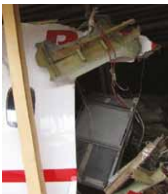
Rozerwane otwory: drzwiowy i okienny, wywinięte na zewnątrz i do góry poszycia.
