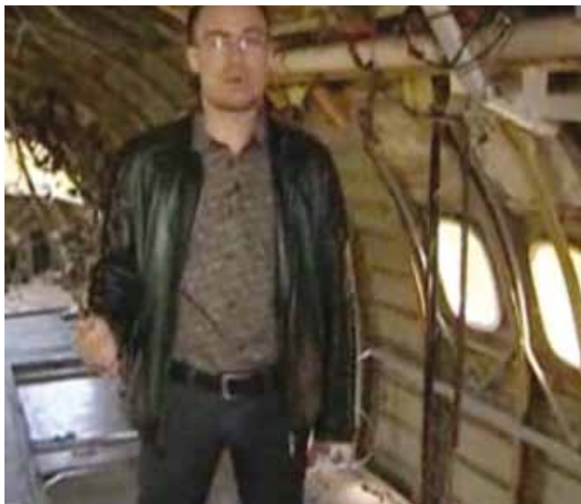
Analogiczny fragment burty z oknami Tu-154M nr 102 podczas remontu w Samarze. Na miejscu zdarzenia brak kolektora gorącego powietrza pod oknami oraz rurek wokółłokiemnych rozprowadzających gorące powietrze wewnątrz konstrukcji poszycia.
