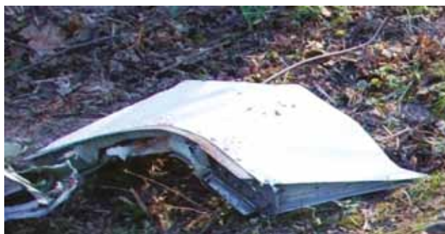
Fragment kłapy zaskrzydłowej rozerwanej wzdłuż tylnej krawędzi podłużnicy.
