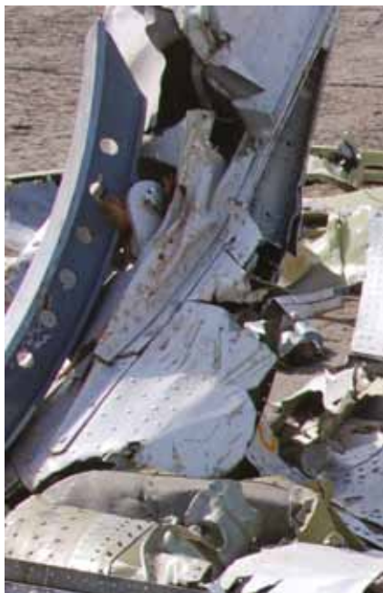
Miejsce w klapie zaskrzydłowej po wyrwanej owiewce prowadnicy nr 5.
