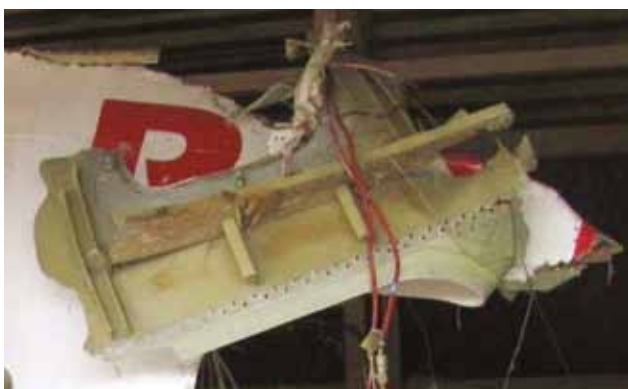
Rozerwane otwory: drzwiowy i okienny, wywinięte na zewnątrz i do góry poszycia.
