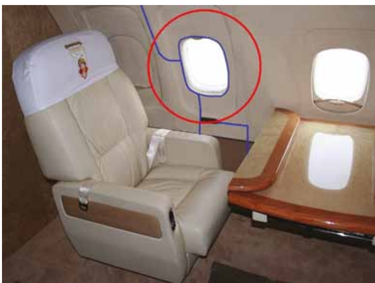
Czerwonym okręgiem zaznaczono okno, którego rozerwane fragmenty omówiono powyżej. Przy tym oknie znajdował się fotel prezydenta. Niebieska linia pokazuje miejsca rozerwania poszycia zewnętrznego.
