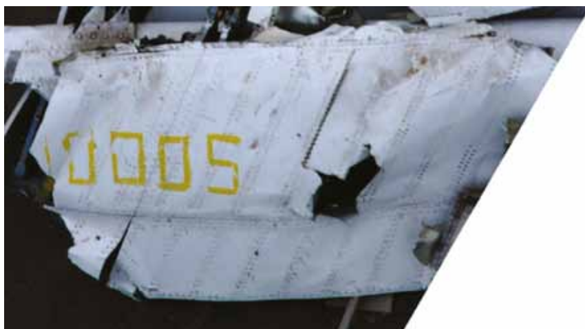
Fragment kłapy zaskrzydłowej rozerwanej wzdłuż przedniej krawędzi podłużnicy. Fragment ten pochodzi z PRAWEGO skrzydła i został ułożony w miejscu „rekonstrukcji” skrzydła lewego.
