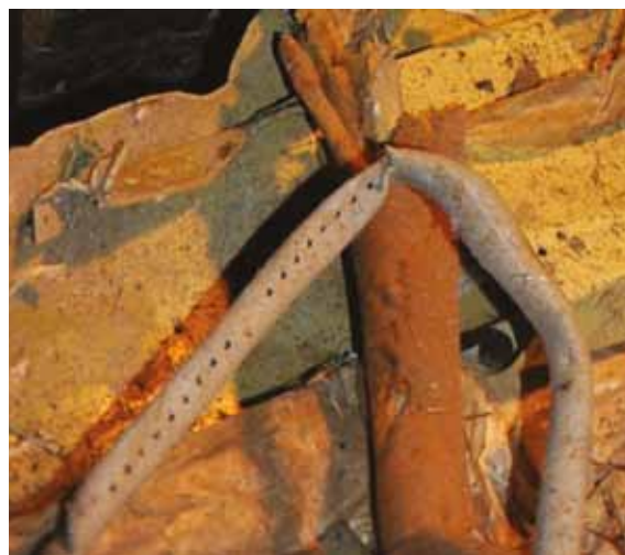
Rozzerwana i powyginana rurka z szeregiem otworów służących do rozprowadzania gorącego powietrza wewnątrz poszycia oraz nadmuchu do ogrzewania przedziału pasażerskiego.
