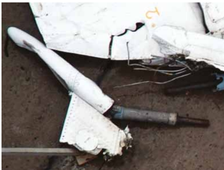
Fragment kłapy zaskrzydłowej rozerwanej wzdłuż tylnej krawędzi podłużnicy.
