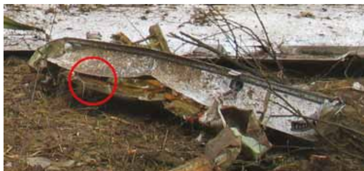
Czerwonym kółkiem zaznaczono fragment prawego obramowania otworu okiennego salonki prezydenckiej.
