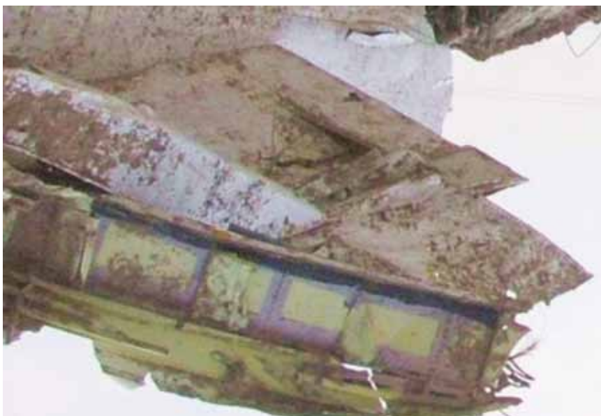
Fragment klapy zaskrzydłowej przy centropłacie z miejscem oderwania owiewki nr 3. Klapa zaskrzydłowa rozerwana wzdłuż tylnej podłużnicy.
