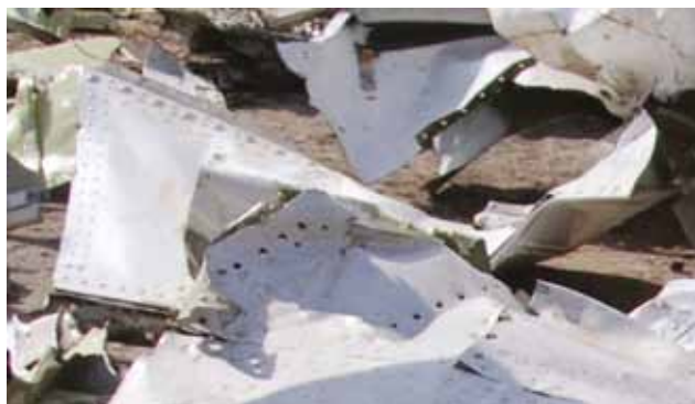
Fragment kłapy zaskrzydłowej (nr 24) rozerwanej wzdłuż tylnej krawędzi podłużnicy.
