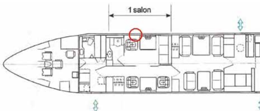
Czerwonym okręgiem zaznaczono miejsce rozerwanego okna salonki prezydenckiej.
