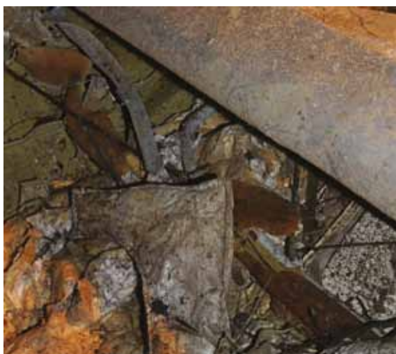
Nadpalona pianka izolacyjna otulająca wręgi samolotu. Widoczny brak materiałów ocieplających burtę.
