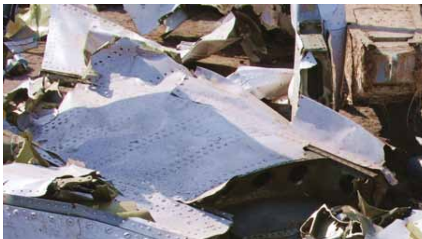
Fragment kłapy zaskrzydłowej (nr 22) rozerwanej wzdłuż przedniej krawędzi podłużnicy.
