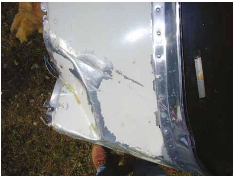
Z kawałków poszycia można odczytać kierunek przemieszczania się kadłuba samolotu
