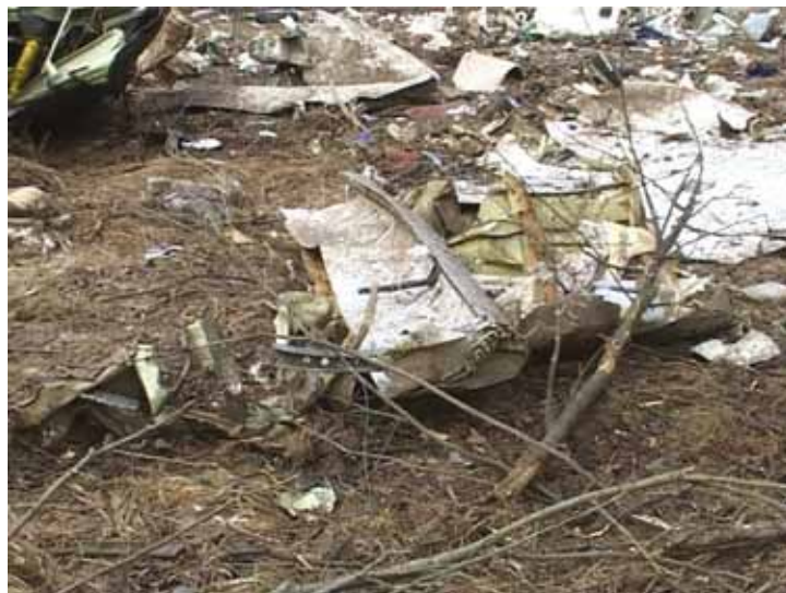
Ad. 2 Fragment wyrwanej prawej burty z salonki prezydenckiej. Widok od środka konstrukcji. Na wierzchu burty leży wyrwany slot prawego skrzydła.
