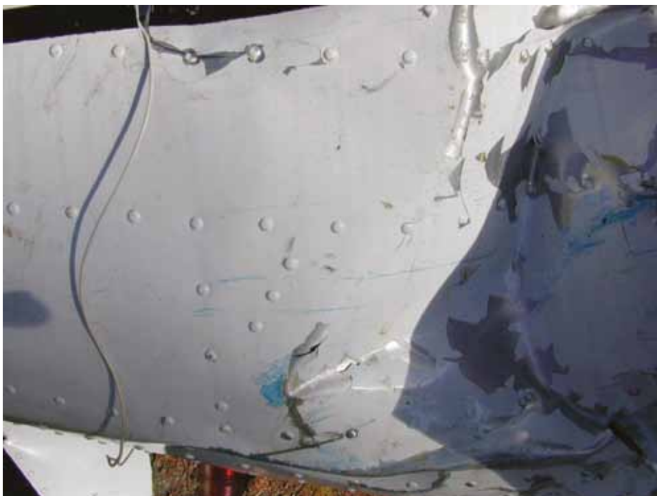
Z tego kawałka poszycia można odczytać dynamikę kolizji. Charakterystyczne jest wgniecenie materiału jako skutku kolizji z twardym obiektem.
