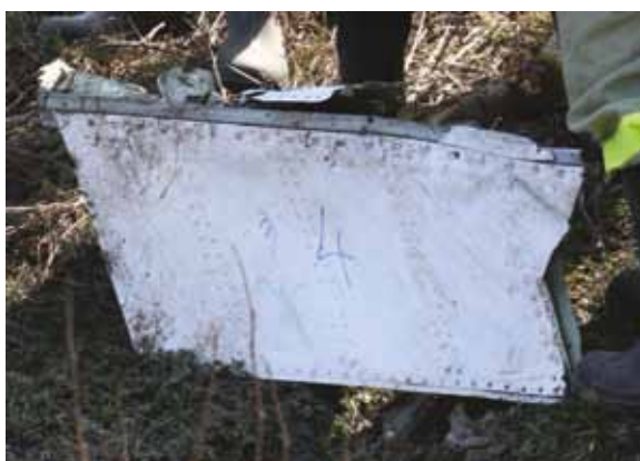
Fragment kłapy zaskrzydłowej (nr 24) rozerwanej wzdłuż tylnej krawędzi podłużnicy.
